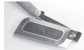
Esiin käännettävä antenni kantaman pidentämiseksi
