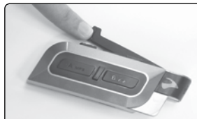
Esiinkäännettävä antenni kantaman laajentamiseksi
